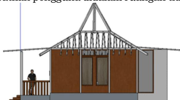
Gambar 4. Desain jendela dan ventilasi silang pada desain rumah tinggal
