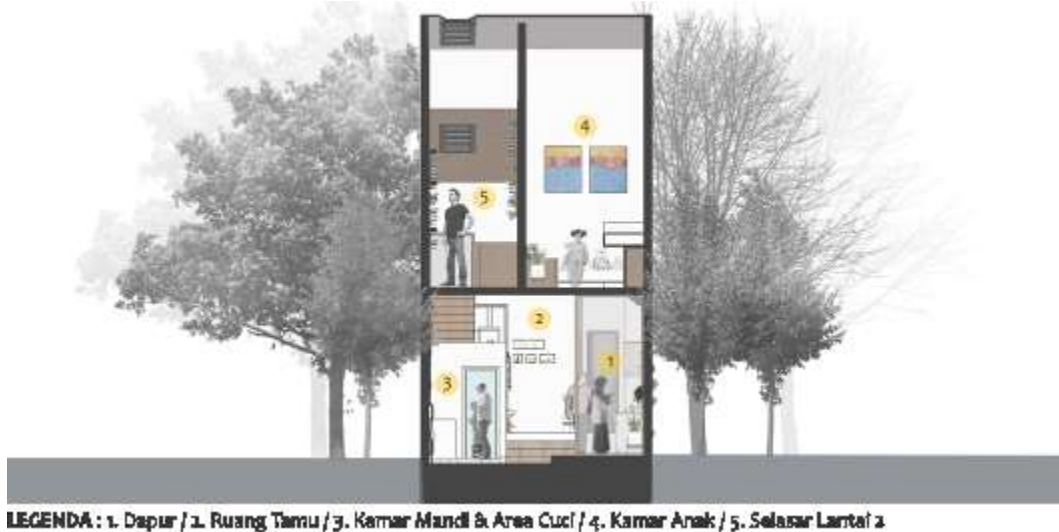
Gambar.4. potongan membujur tiny house
