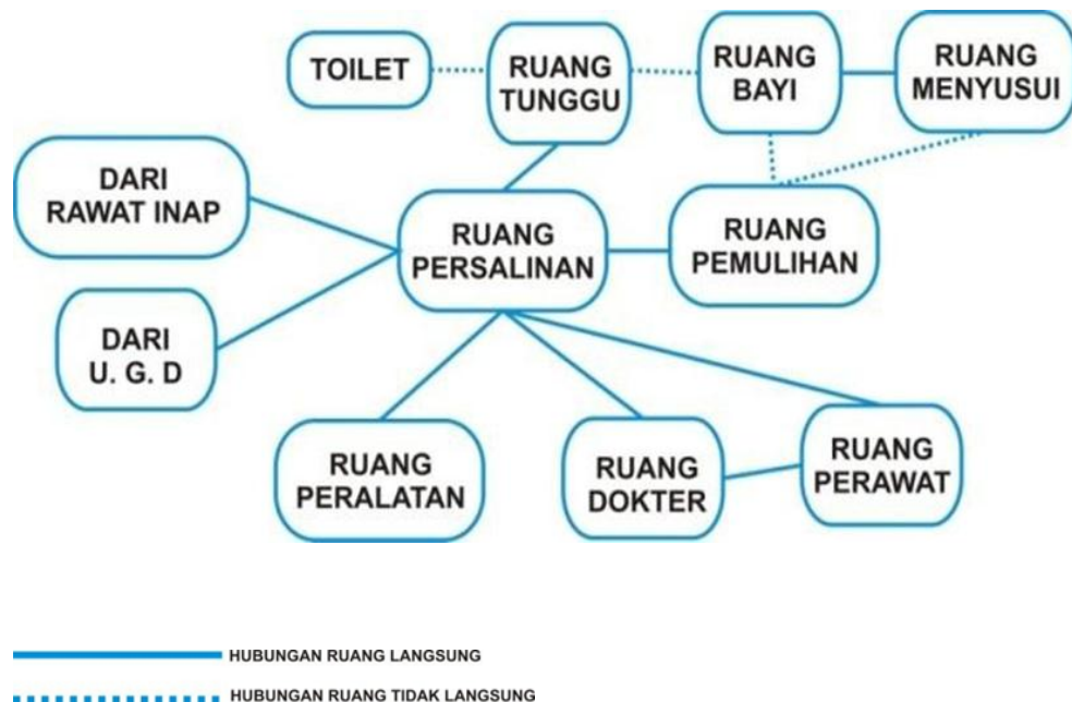
Gambar 8. Konsep alur dan posisi penempatan ruang IRNA ibu dengan instalasi terkait agar percepatan penanganan dan penyembuhan dapat berjalan dengan lancar
