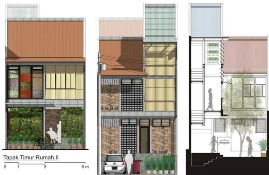
**Gambar 9.** Tampak dan potongan rumah tahap ke-3 (optimal) pengembangan
