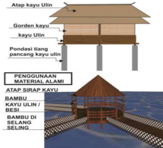
Gambar 7. Penggunaan Sistem Struktur Terapung dengan Sistem Rakit Sumber: Analisis Penulis, 2019
